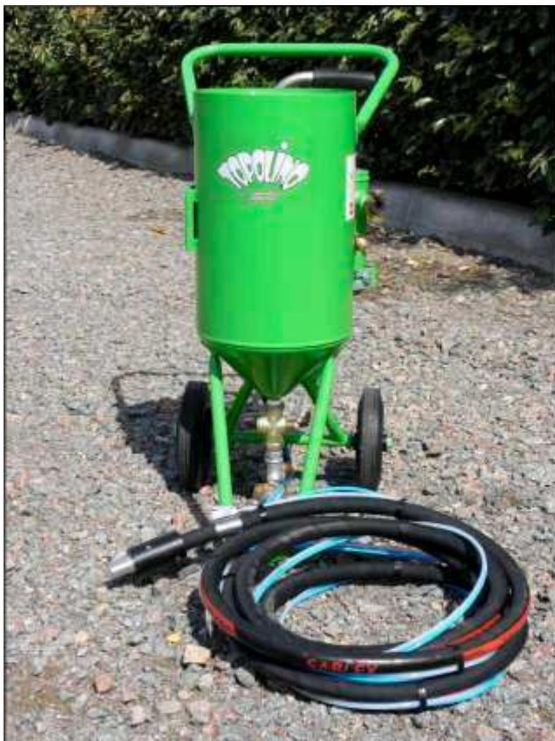
**Matériel complet peu encombrant pour la gravure dans les cimetières. Equipé d'un filtre avec cartouche à charbon actif, manomètre de réglage de la pression de sablage, télécommande, couvercle de protection. Très efficace pour le nettoyage et de décapage de toutes surfaces intérieures et extérieures.**
